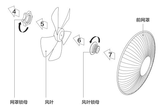
● 顺时针旋紧网罩 ● 安装风叶后,用手 锁母,同时固定
